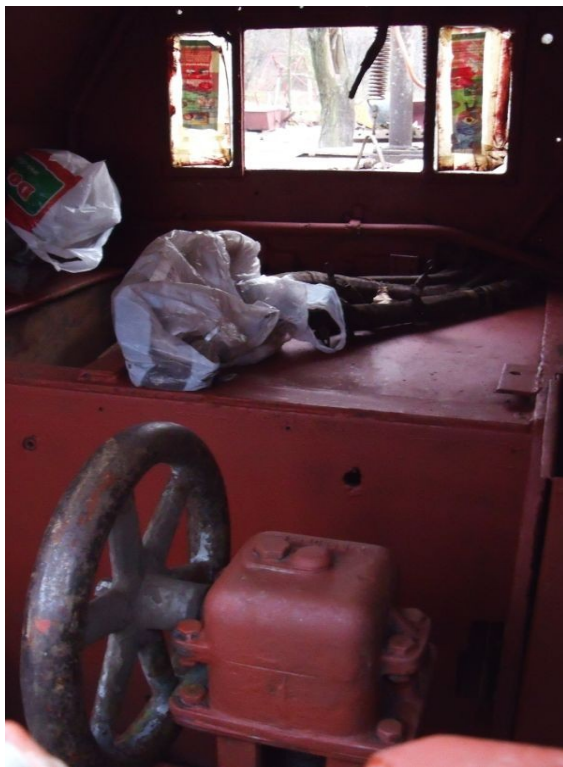
A GANZ 9 tonnás vezérállása, az ablak alatti polc várja vissza a kontrollert, az előtérben a kézifék kereke.
